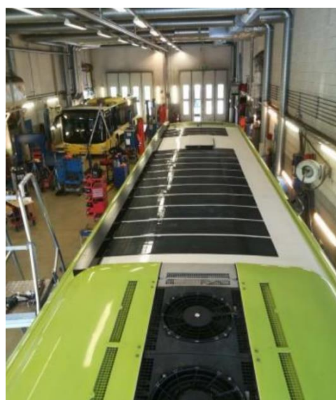
【フレキシブルソーラーパネル（バス天井装着例）】
